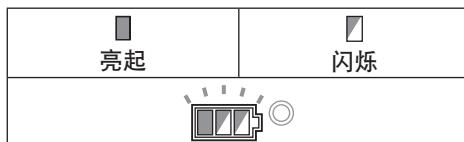
如果无法启动工具，则电池可能过热。在这种情况下，请待电池冷却后再启动工具。
