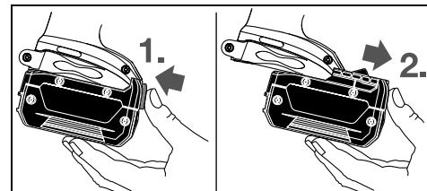
Để tháo pin 8, nhấn nút nhả khóa 9 và kéo hết pin ra về phía trước. Không dùng lực cưỡng ép.
