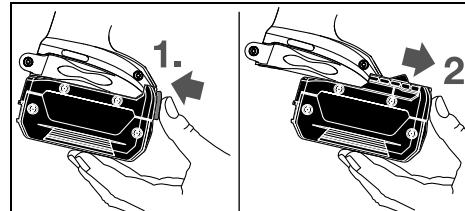
拆卸蓄电池 8 时先按下解锁按键 9 接著再向前从电动工具中拉出蓄电池。不可以强行拉出蓄电池。
