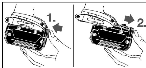
Para desmontar el acumulador **8** presione el botón de extracción **9** y saque el acumulador de la herramienta eléctrica tirando de él hacia delante. **No proceda con brusquedad.**
