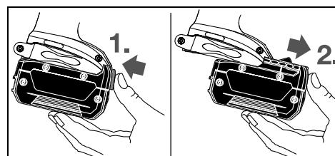
拆卸蓄電池 8 時先按下解鎖按鍵 9，接著再向前從電動工具中拉出蓄電池。不可以強行拉出蓄電池。
