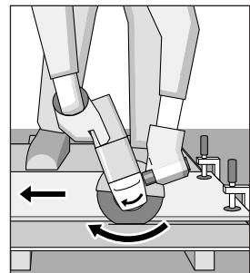
▪ هنگام برش بروفیل ها و لوله های چهارضلعی، بهتر است از کوچکترین ضلع مقطع برش شروع بکار کنید.
