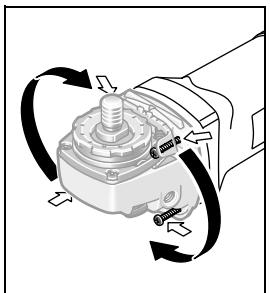
หัวเครื่องสามารถหมุนท่ามกลางกันตัวลังเครื่องได้เป็นชั้น ขั้นละ  $90^{\circ}$  ในลักษณะนี้ลิวิท์ช์ปิด-ปิดสามารถเลื่อนไปอยู่ในตำแหน่งที่สะดวกของการใช้งานมากขึ้นเมื่อทำงานในสถานการณ์พิเศษ ด. ย. เช่น สำหรับการตัดที่ใช้แผ่นนำการตัดพร้อมฝารอบคูณ 20 หรือสำหรับผู้คนมือซ้าย
