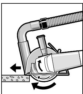
เปิดเครื่องทำงาน และวางส่วนหน้าของแผ่นนำการดัดบนหินางาน เครื่องนึ่งไว้ทางหน้าด้วยความเร็วพอประมาณที่เหมาะสมกับลักษณะที่กำลังตัดอยู่ เมื่อดัดวัสดุที่แข็งเป็นพิเศษ ต. ย. เช่น คอนกรีต ที่มีกรวดผสมอยู่มาก งานตัดเพชรจะร้อนเกินไป และด้วยเหตุนี้จะชำรุดได้ ซึ่งจะลังกัด
